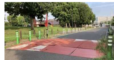
ハンプ(凸部):車の速度を落とすことを目的とし、道路上に設置されるものです。
